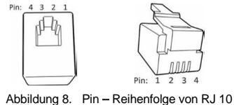
Abbildung 8. Pin – Reihenfolge von RJ 10
