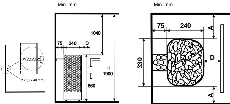
Abbildung 4. Installation des Saunaheizgeräts
