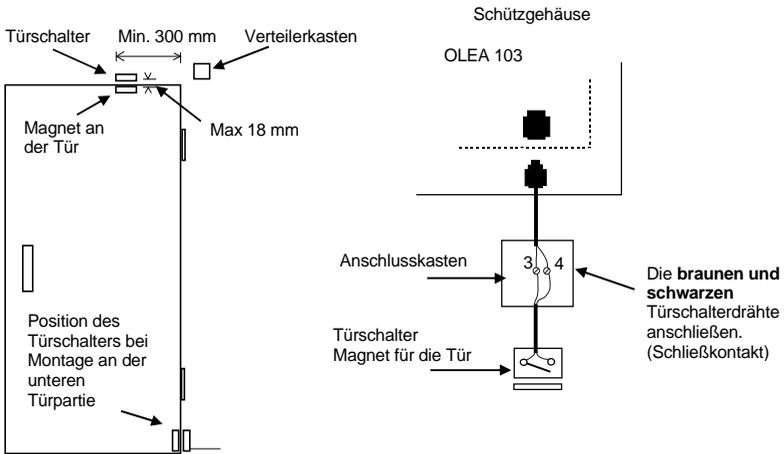
Abbildung 7. Installation des Türschalters
